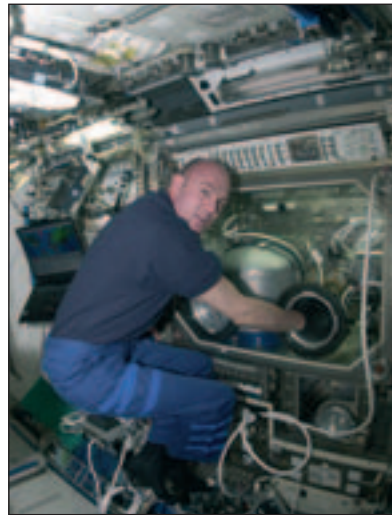
André Kuipers doet zijn experimenten in een Microgravity Science Glovebox, die door Bradford Engineering is ontworpen en gebouwd.
